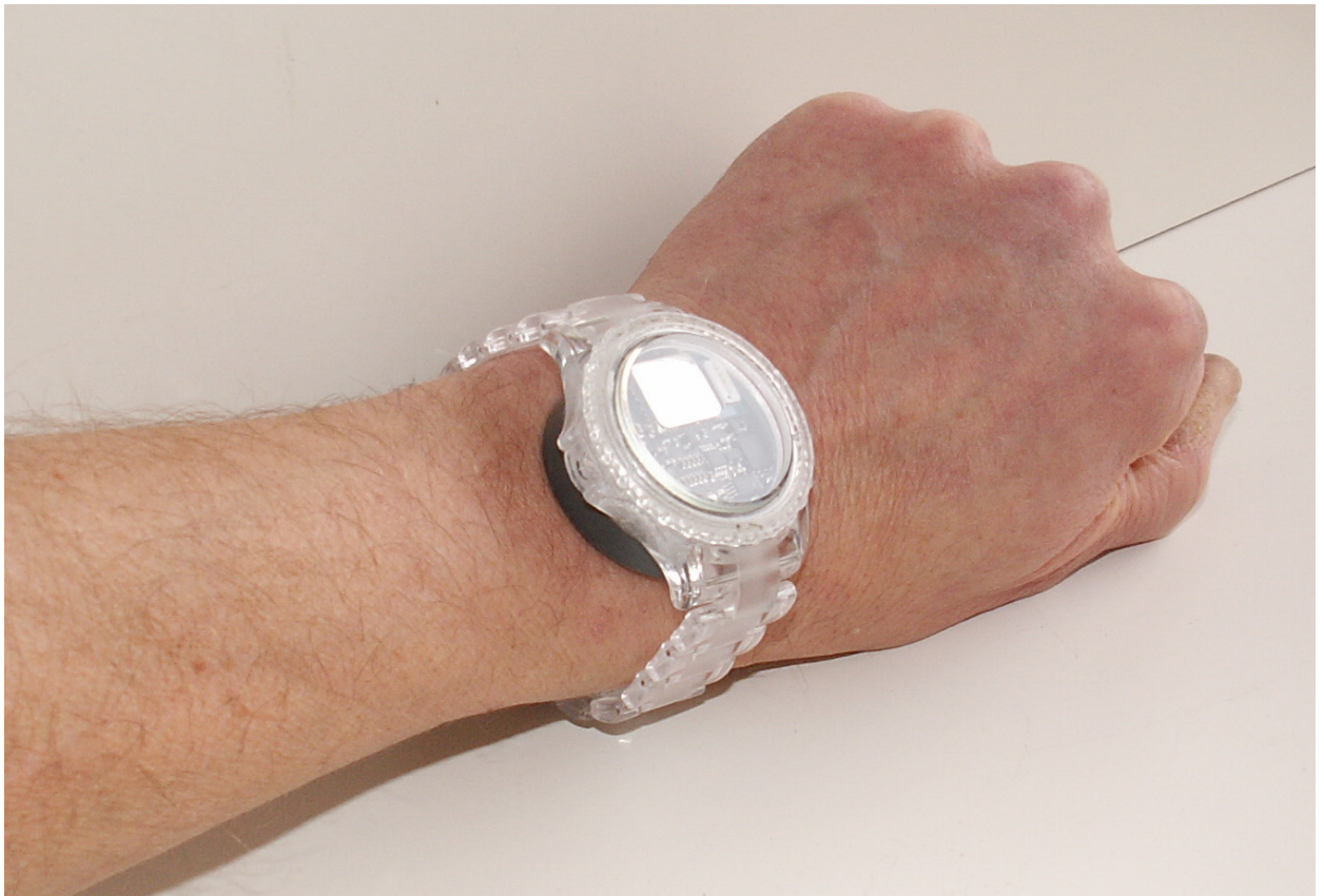
Bildtext, bild nummer åtta: Mätdatainsamlaren från översidan
